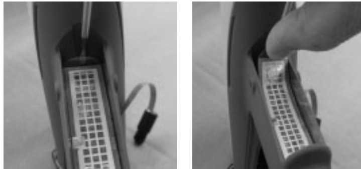
Figura 6-8 Extracción del interruptor de activador de la empuñadura
