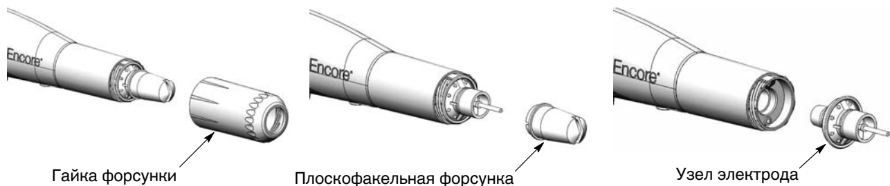
Рис. 4-7 Замена плоскофакельных форсунок
