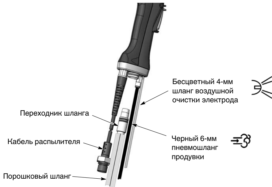
Рис. 3-12 Подключение распылителя
