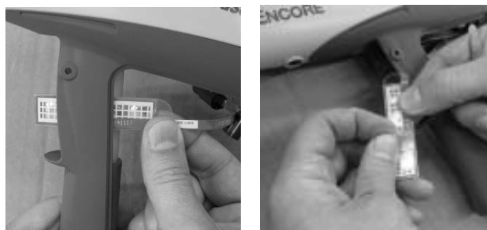
Figura 6-9 Installazione dell'interruttore dell'azionamento - Punti 1 e 2
