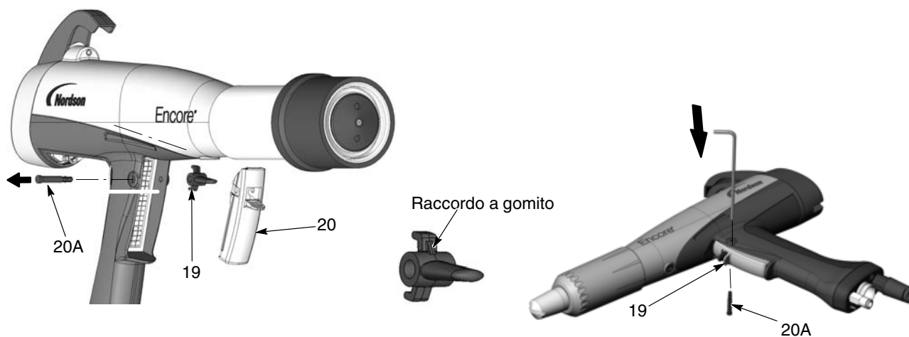
Figura 6-7 Rimozione dell'asse e dell'azionamento dall'impugnatura
