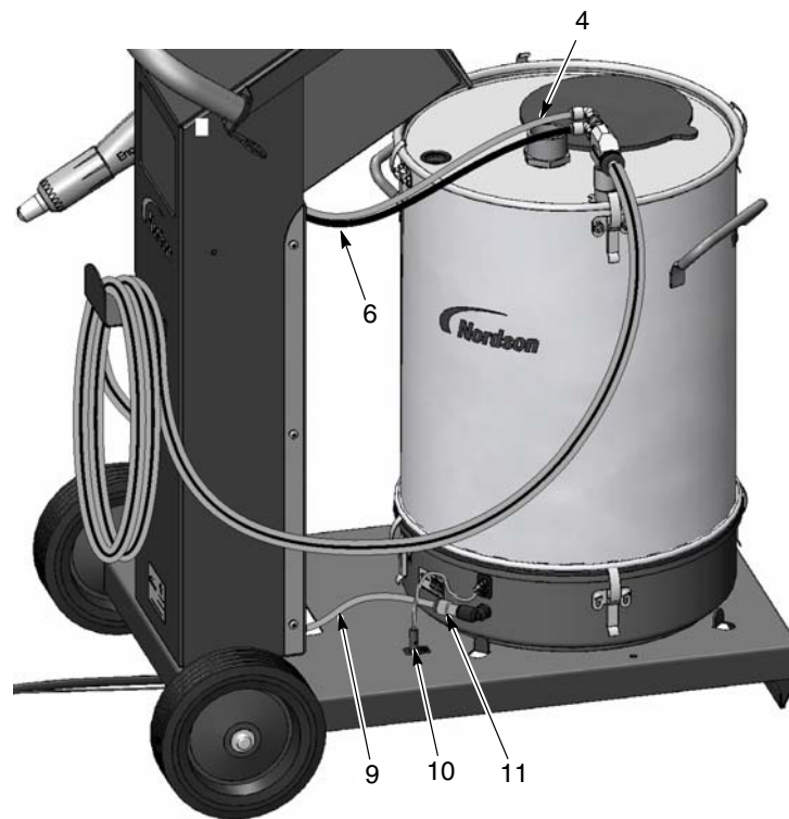
Figura 3-9 Sistema mobile Encore LT con tramoggia - Installazione della tramoggia e della pompa
