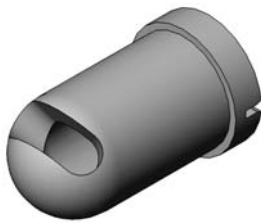
Figura 7-5 Ugello per spruzzo angolato a 45 gradi
