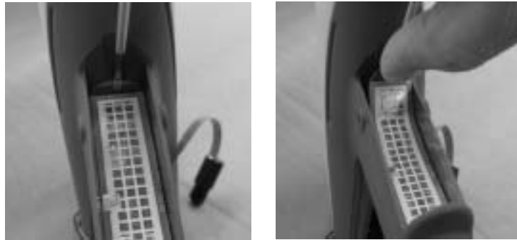
Kuva 6-8 Liipaisukytkimen poistaminen kädensijasta
