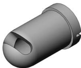
Joonis 7-5 45 kraadi all olev nurkne pihustusotsak
