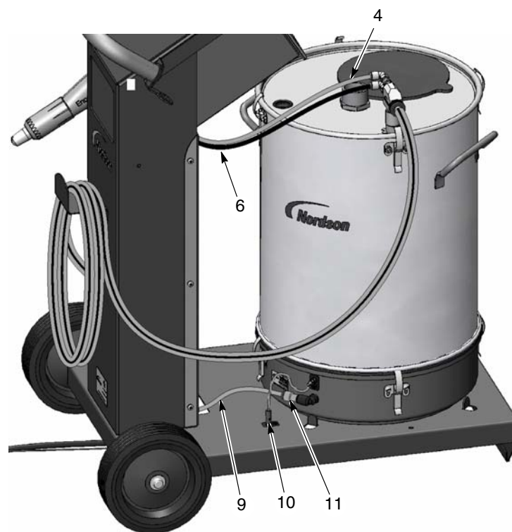
Afbeelding 3-9 Mobiel Encore LT-systeem met hopper - installeren van hopper en pomp
