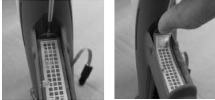
Afbeelding 6-8 Triggerschakelaar verwijderen van de pistoolgreep
