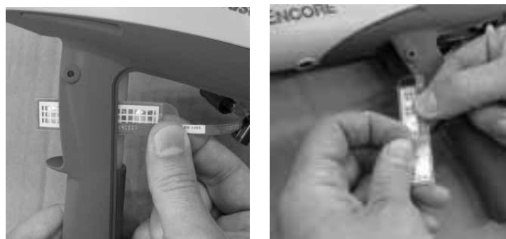
Figur 6-9 Installation af triggerkontakt - Trin 1 og 2
