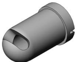
Obrázek 7-5 Rohová stříkácí tryska s úhlem 45 stupňů
