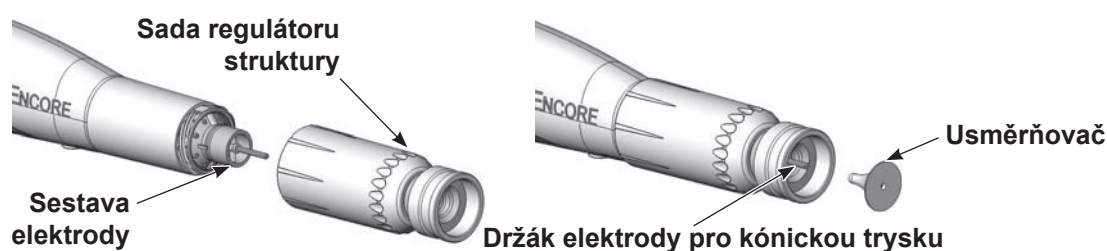
Obrázek 4-9 Instalace sady regulátoru struktury
