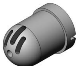
Obrázek 7-6 Plochá stříkácí tryska s úhlem 45 stupňů
