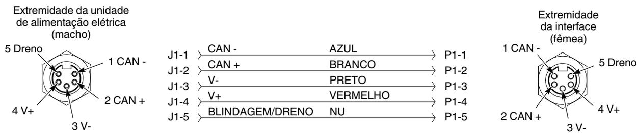
Figura 5-3 Ligações elétricas do cabo de interligação do controlador
