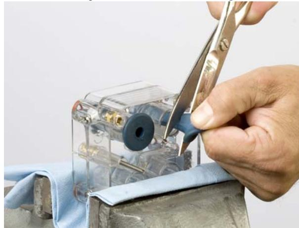
Figura 6-9 Remoção da válvula de manga flexível
