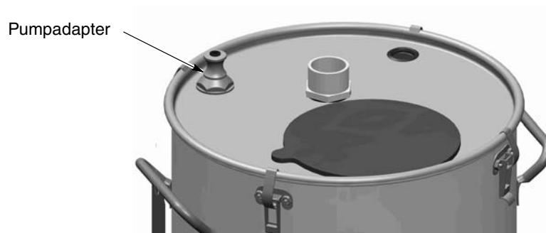
Bild 3-13 Pumpmontage med adapter på hopprar av typ HR eller NHR
