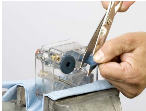
Demontering av strypventil
