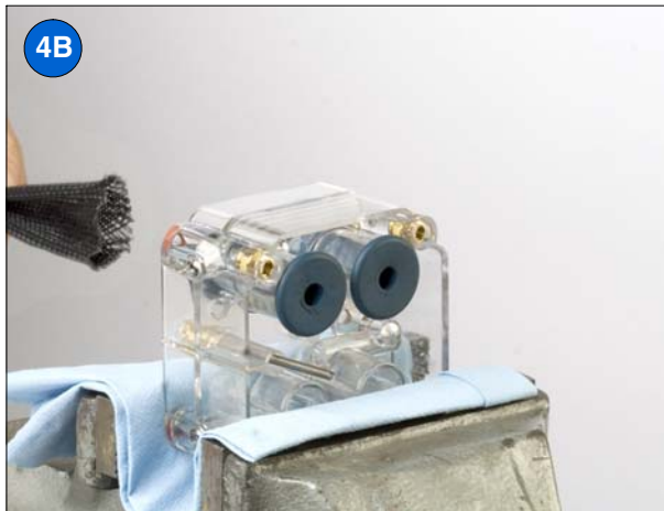
Slika 6-7 Koraki za vgradnjo ščipalnega ventila
