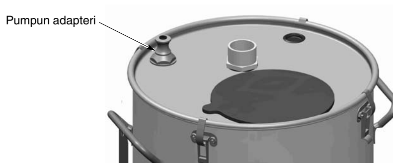
Kuva 3-13 Pumpun asennus sovitesarjalla HR:n tai NHR:n säiliöihin
