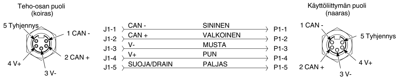
Kuva 5-3 Ohjaimen välikaapelin testaus
