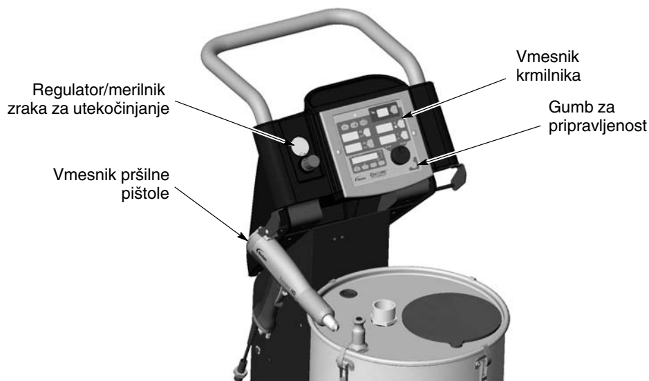
Slika 4-5 Elementi za upravljanje sistema
