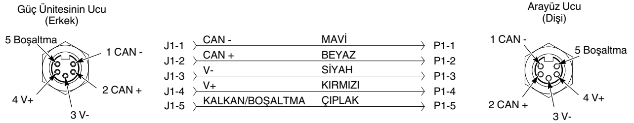
Şekil 5-3 Kontrol Ünitesi Ara Bağlantı Kablo Tesisatı
