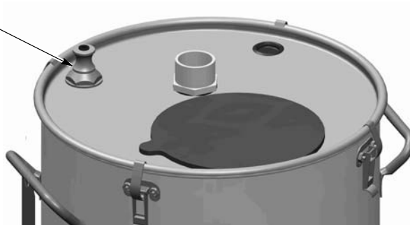
Рис. 3-13 Монтаж насоса с переходником на питателе HR или NHR
