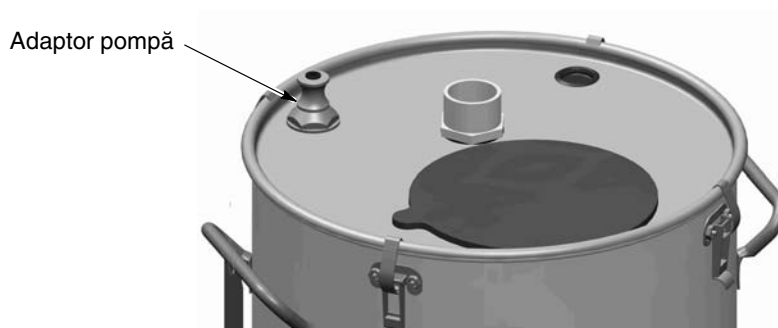
Figura 3-13 Montarea pompei cu adaptor pe buncărele HR sau NHR
