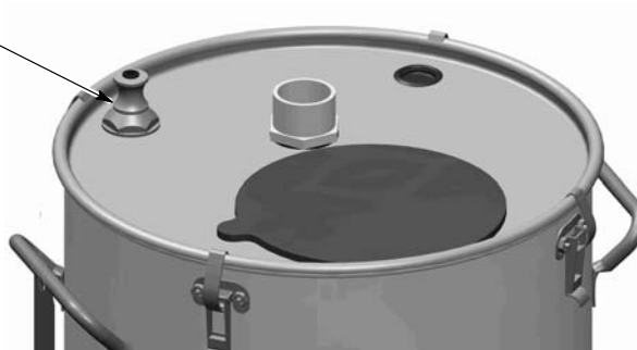
Figure 3-13 Montage de la pompe avec l'adaptateur sur les trémies HR ou NHR
