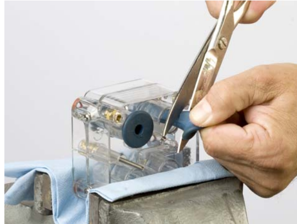
Dépose de la valve à étranglement
