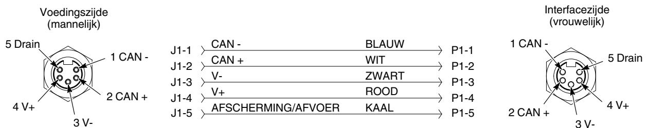
Afbeelding 5-3 Aders in verbindingskabel besturing
