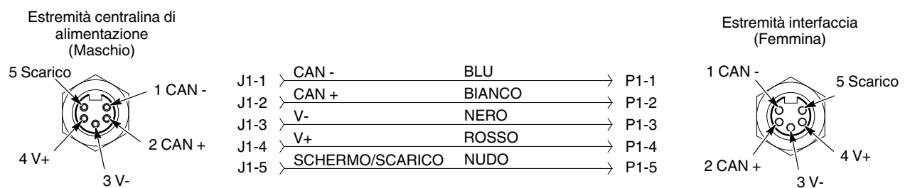
Figura 5-3 Cablaggio del cavo di interconnessione del controller
