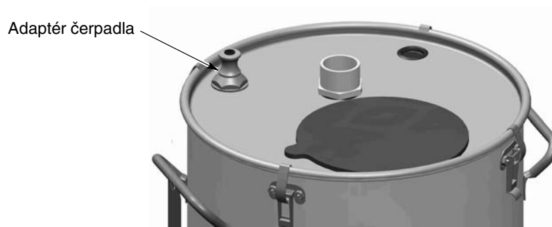
Obrázek 3-13 Montáž čerpadla pomocí adaptéru nebo zásobníků HR nebo NHR
