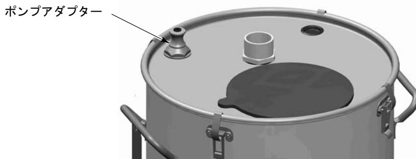
図 3 - 13 HRまたはNORホッパのアダプターによるポンプの取り付け
