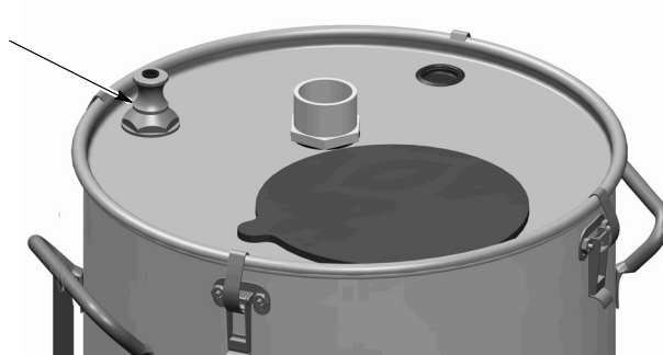
图 3 - 13 带接合器的泵安装（在HR或NHR料斗上）
