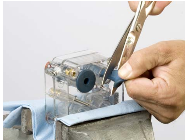
Extracción de las válvulas peristálticas
