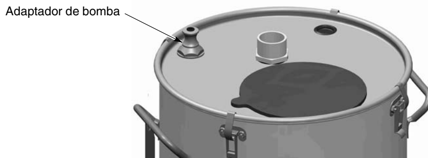
Figura 3-13 Montaje de la bomba con adaptador en tolvas HR o NHR
