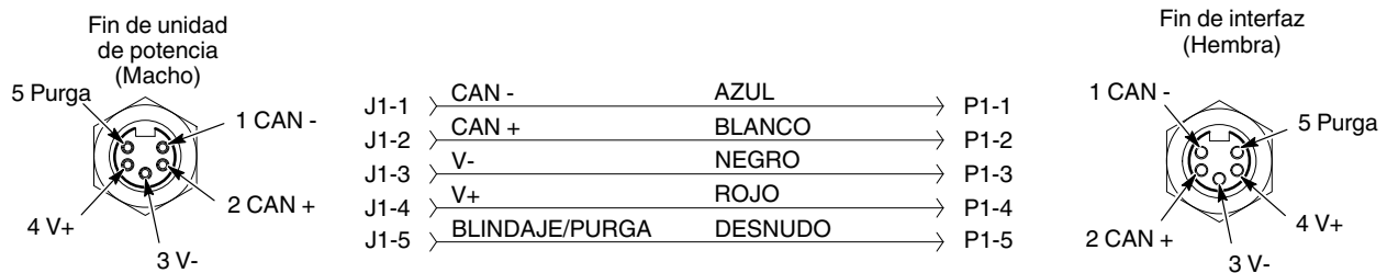
Figura 5-3 Cableado de interconexión del controlador
