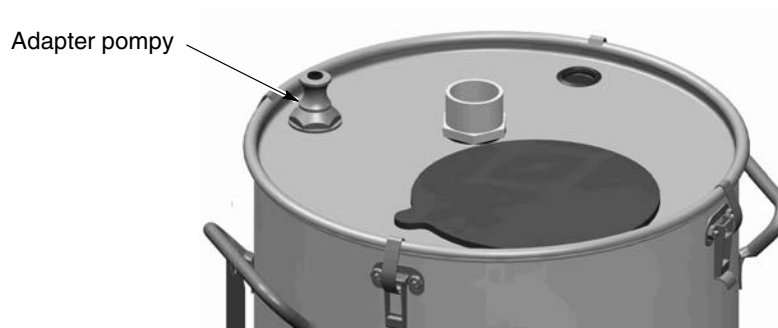
Rys. 3-13 Montaż pompy z adapterem w zasobnikach HR lub NHR
