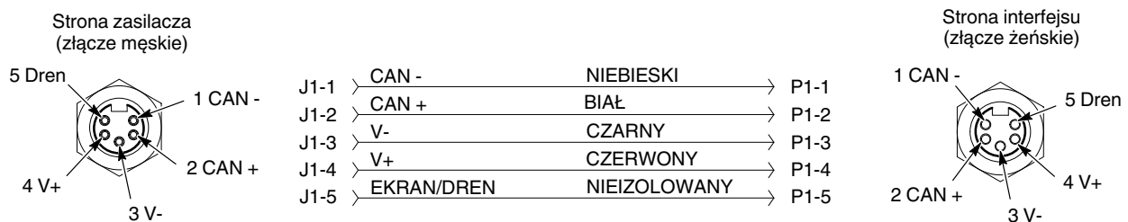
Rys. 5-3 Test kabli połączeniowych sterownika
