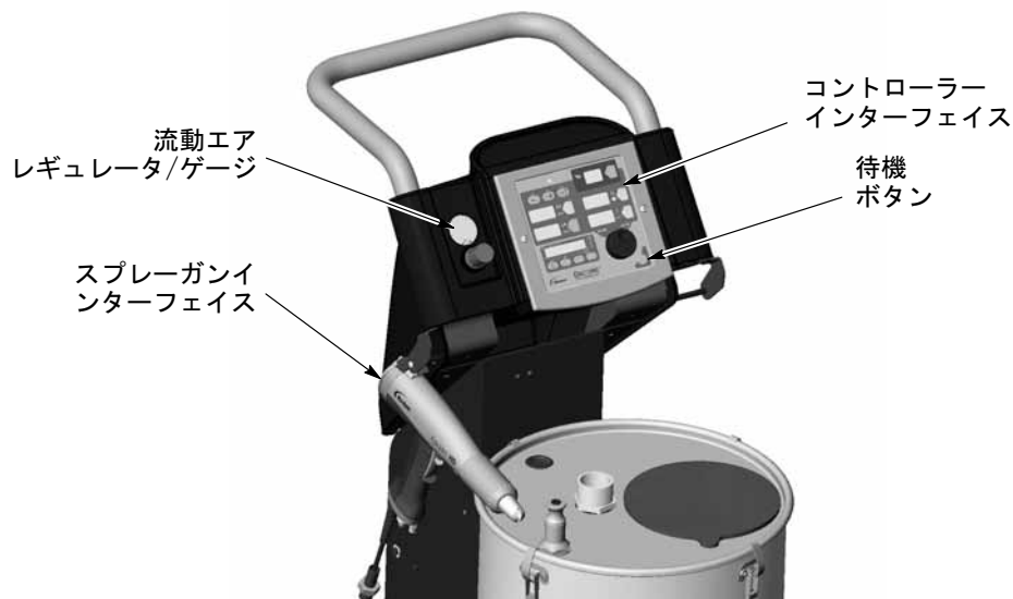
図 4 - 5 システムコントロール
