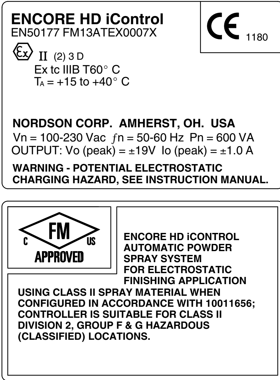
Rys. 2-4 Etykiety z informacjami o dopuszczeniach na sterowniku iControl Encore HD
