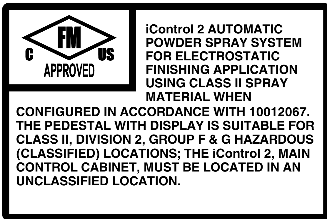
Rys. 2-8 Etykieta certyfikatu FM (na szafce głównej, dodatkowej oraz na stojaku)
