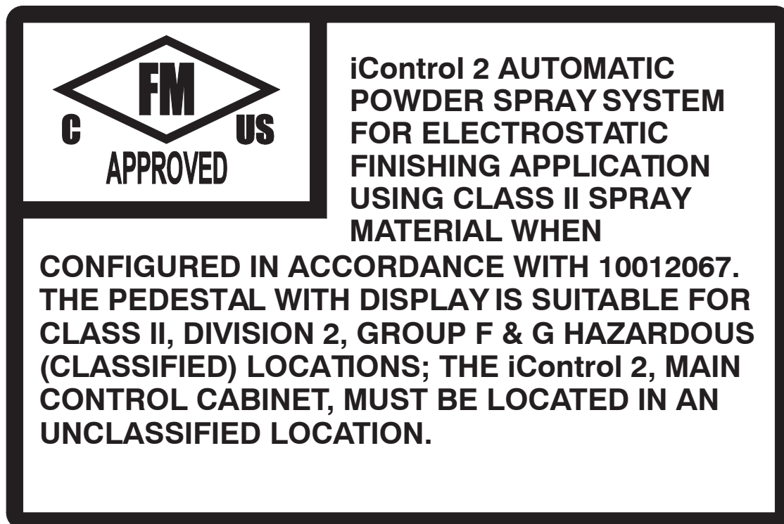
Figura 2-7 Etiqueta para homologación FM (en los armarios principal, auxiliar y del pedestal)
