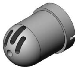
Slika 7-6 45-stopinjska šoba za plosko pršenje
