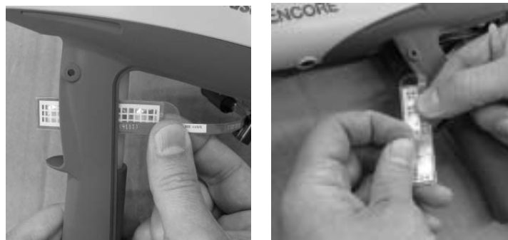
Slika 6-9 Vgradnja stikala sprožilca - koraka 1 in 2
