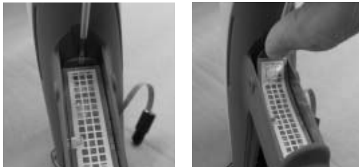
Slika 6-8 Odstranjevanje stikala sprožilca iz ročaja
