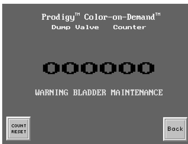
Figura 4-16 Pantalla de contadores de válvula
