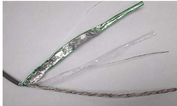
Figura 3-9 Terminación del cable Ethernet, pasos 3-4
