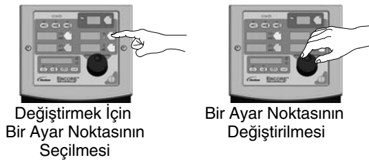
Şekil 9 Ayar Noktalarının Seçilmesi ve Değiştirilmesi
