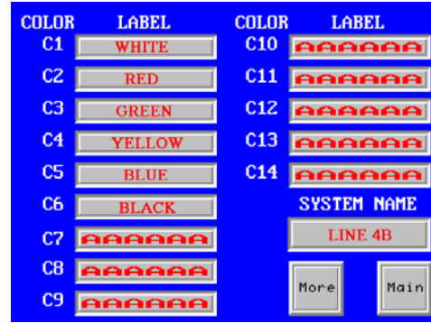
Şekil 6 Renk Kumanda Butonu Etiket Ekranı
