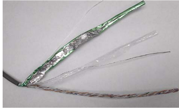
Şekil 3-9 Ethernet Kablosu Bağlantı Ucu, Adım 3-4
