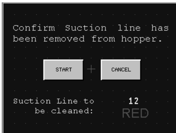
Figure 4-15 Écran affiché pendant la purge ACTUELLE de la conduite d'aspiration
