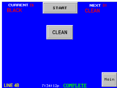
Abb. 4 Spülmenü der Farbsteuerung
