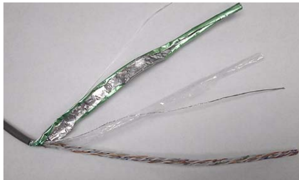
Slika 3-9 Zaključitev kabla Ethernet, koraki od 3 do 4
