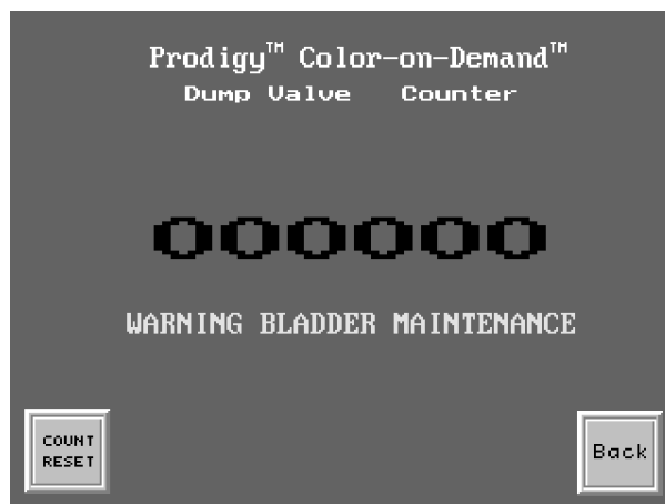
Slika 4-16 Zaslon števca ventilov
