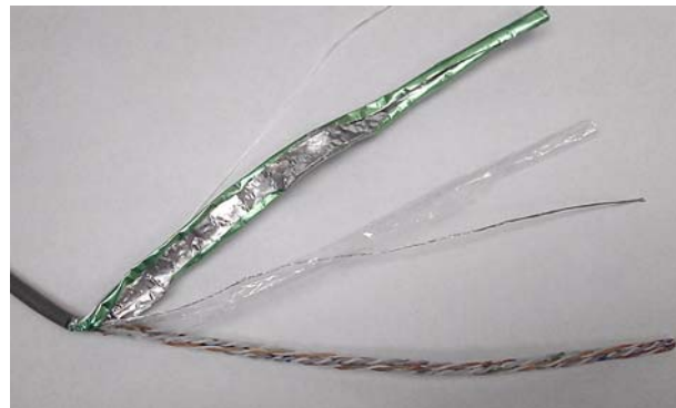
Figura 3-9 Terminação do cabo de Ethernet, passos 3-4.
