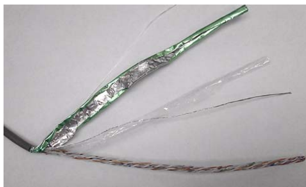
Rysunek 3-9 Zakończenie kabla Ethernet, etap 3-4
