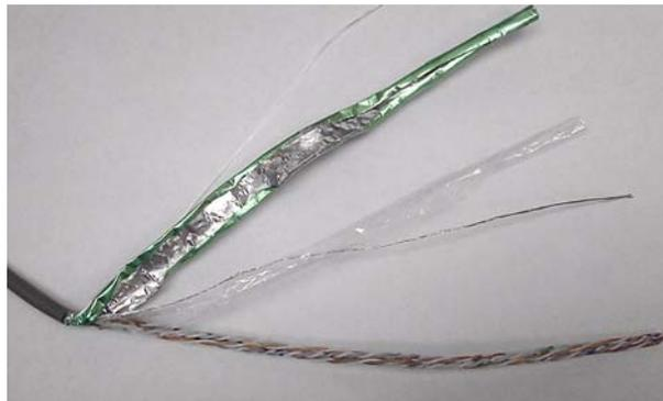
Abbildung 3-9 Ethernetkabelabschluss, Schritte 3-4
