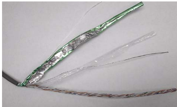
Kuva 3-9 Ethernet-kaapelin terminointi, vaiheet 3-4
