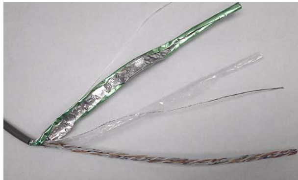
Afb. 3-9 Afsluiting ethernetkabel, stap 3-4
