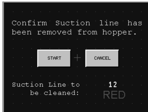
Afb. 4-15 Weergave op scherm voor HUIDIGE spoeling van aanzuigleiding
