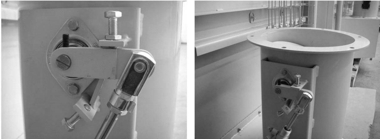
Figura 3-24 Ajuste de tajadera, posición de flujo bajo ajustado
