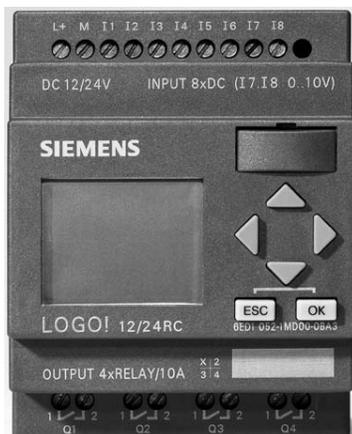
Figura 4-26 Interfaz del PLC del centro de alimentación
