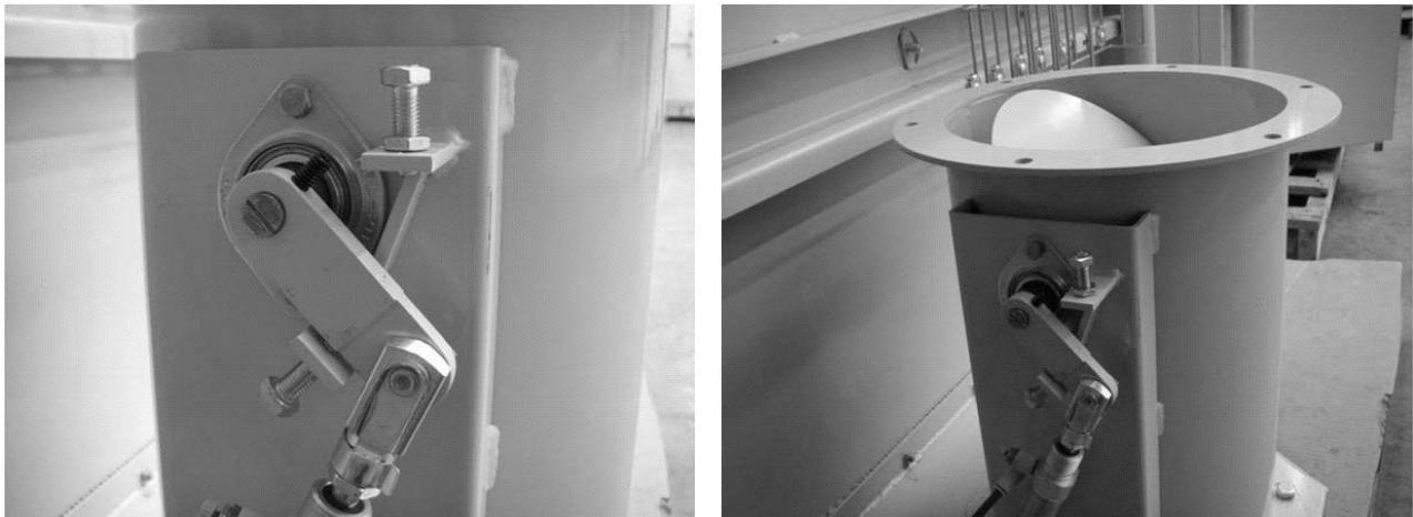
Figura 3-23 Ajuste de tajadera, posición de flujo alto ajustado de fábrica
