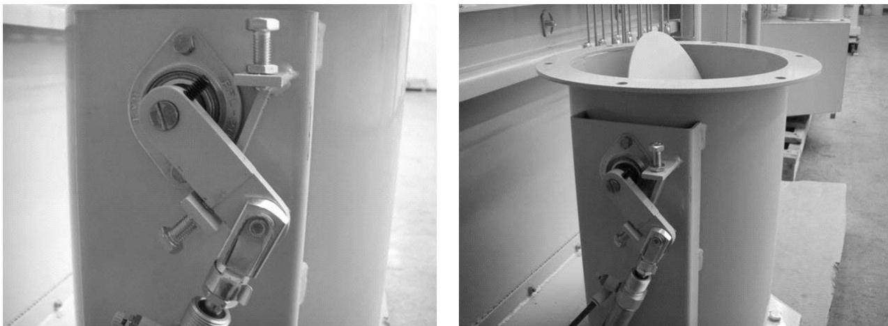
Figura 3-25 Ajuste de tajadera, posición de flujo alto ajustado
