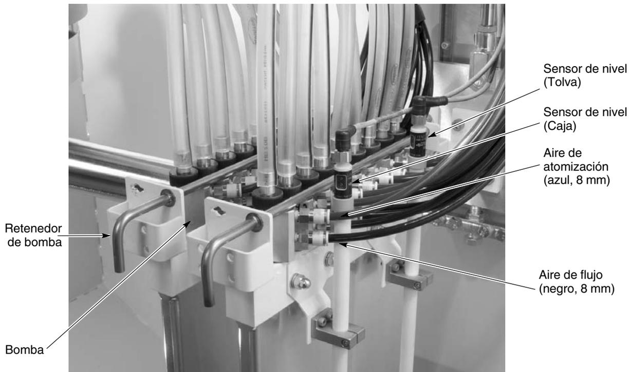
Figura 3-15 Bomba, tubo de aire, e instalación de la manguera de alimentación de polvo
