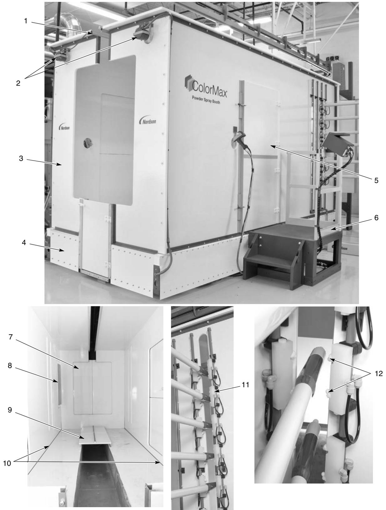
Figura 2-2 Componentes de la cabina
