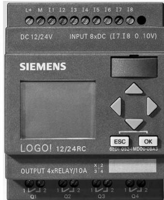
Figura 3-1 Interfaz del PLC del centro de alimentación
