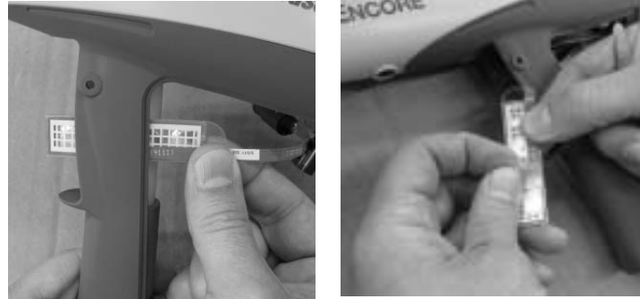
Şekil 6-9 Tetikleyici Düğmesinin Takılması - Adım 1 ve 2
