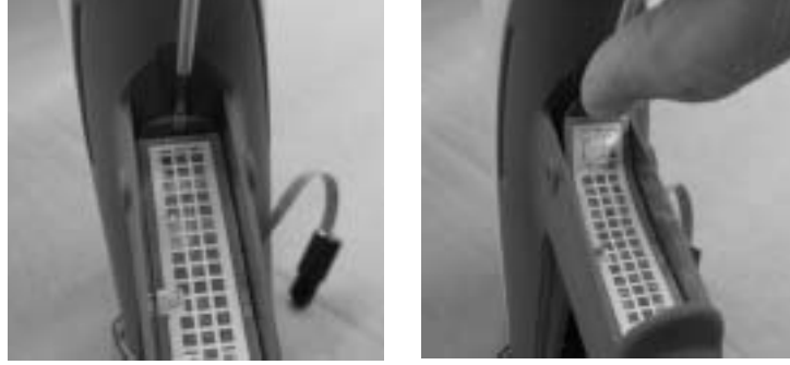
Şekil 6-8 Tetikleyici Düğmesinin Tutamaktan Çıkartılması
