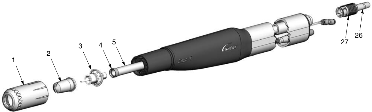
Şekil 16 Tozdan Aşınma Parçalarının Değişimi
