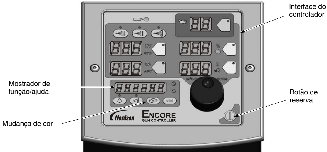
Figura 4-1 Comandos do sistema - sistema móvel ilustrado
