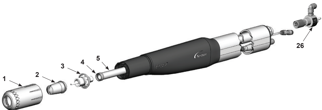
Figure 7-1 Remplacement des pièces d'usure en contact avec la poudre
