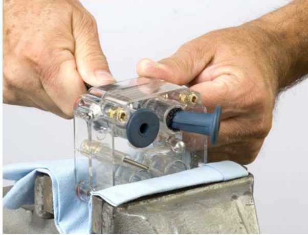
Şekil 15 Esnek Valfin Valf Gövdesine Çekilmesi
