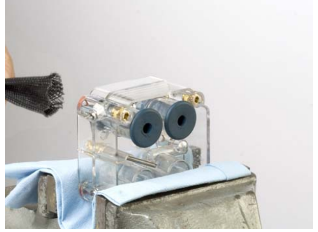
Şekil 16 Esnek Valfin Valf Gövdesinden Çekilmesi
