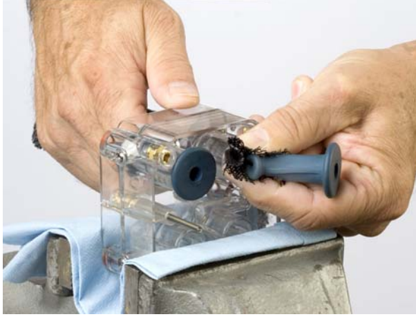
Şekil 14 Esnek Valf YUKARI Flanşının Düz Şekilde Sıkıştırılması
