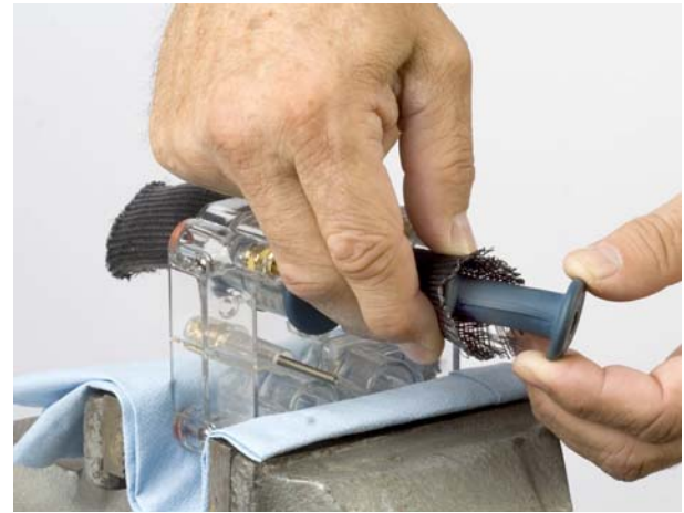
Şekil 13 Esnek Valfin Ekleme Aracına Takılması
