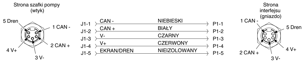
Rys. 5-2 Test kabli połączeniowych sterownika
