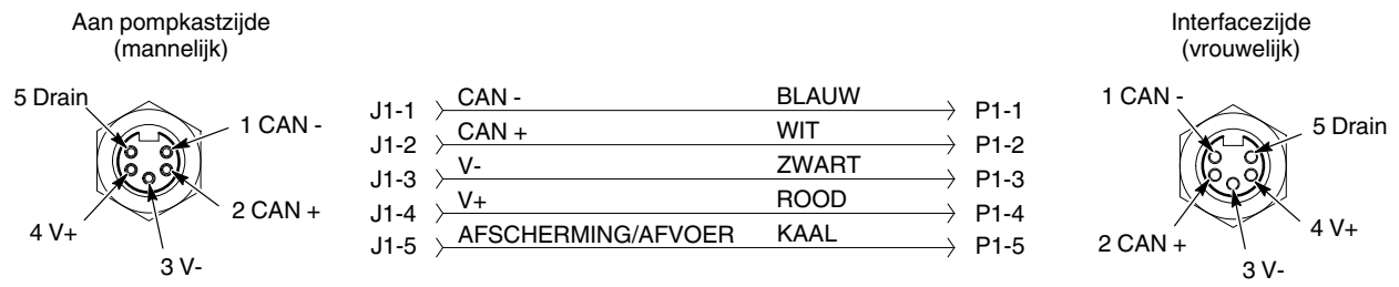
Afbeelding 5-2 Aders in verbindingskabel besturing
