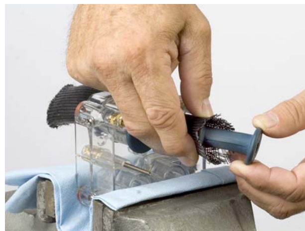
Figur 13 Indføring af klemmeventil i indsætningsværktøj
