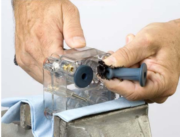
Figur 14 Klemmeventilens UP-kant klemmes flad
